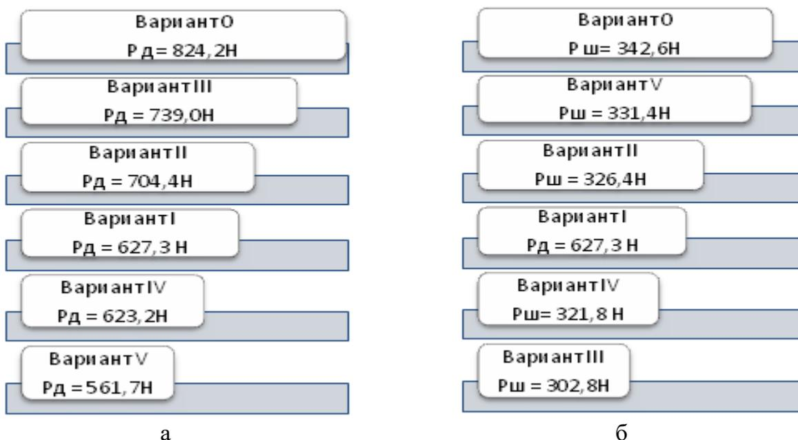
Рис. 1. Разрывная нагрузка неполного трикотажа по длине (а) и по ширине (б)
